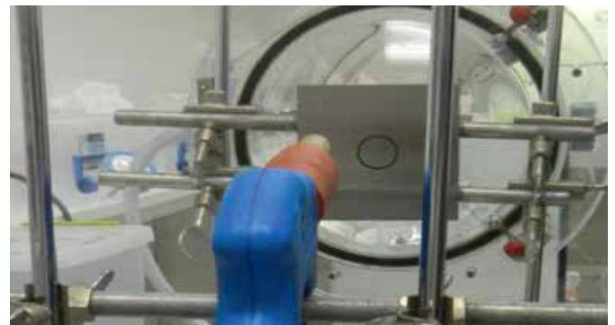
An genau definierten Punkten werden die kontaminierten Platten mit dem Dampfreiniger „bearbeitet“
